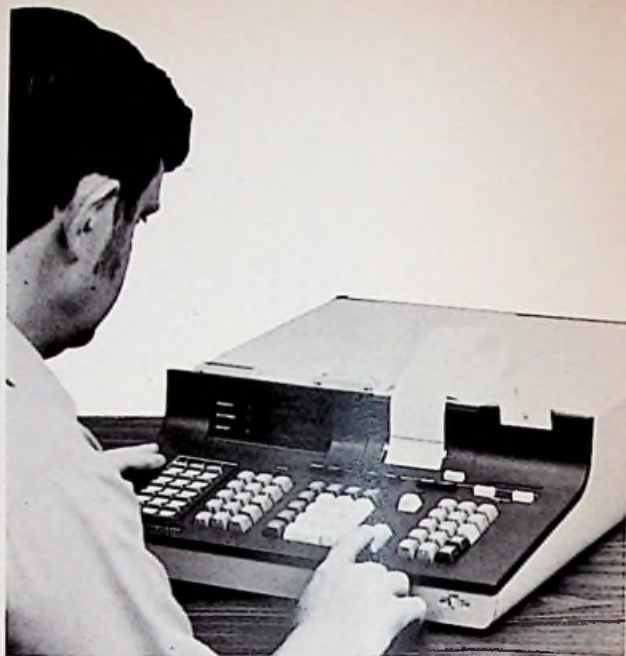
Afb. 2. LED-uitleestableau, mozaïekprinter (voor alfanumerieke tekens) toetsenbord en magneetkaartlezer/schrijver zijn de kenmerken van de HP Model 10 „sophisticated“ tafelrekenmachine.
