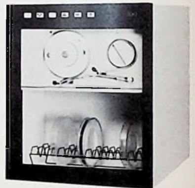
NCR 723 verzamelstation voor maximaal 48 kasregisters. de magneetband kan door een computer worden uitgewerkt.
