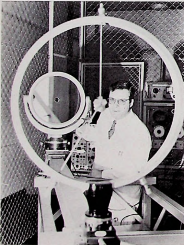
Op de voorgrond de convexe oculaire spiegel, daarachter de concave objectieve spiegel met het centrale gat waarachter de laserzender resp. de fotodetector staat opgesteld.
