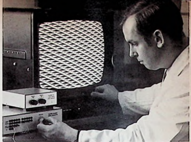
Afb. 1. De pseudo-ruisgenerator, met daarboven het hulpapparaat voor het verkrijgen van elektronische testbeelden-in-kleur. Op het beeldscherm een op deze wijze verkregen beeld (zie ook de omslag van dit nummer).
